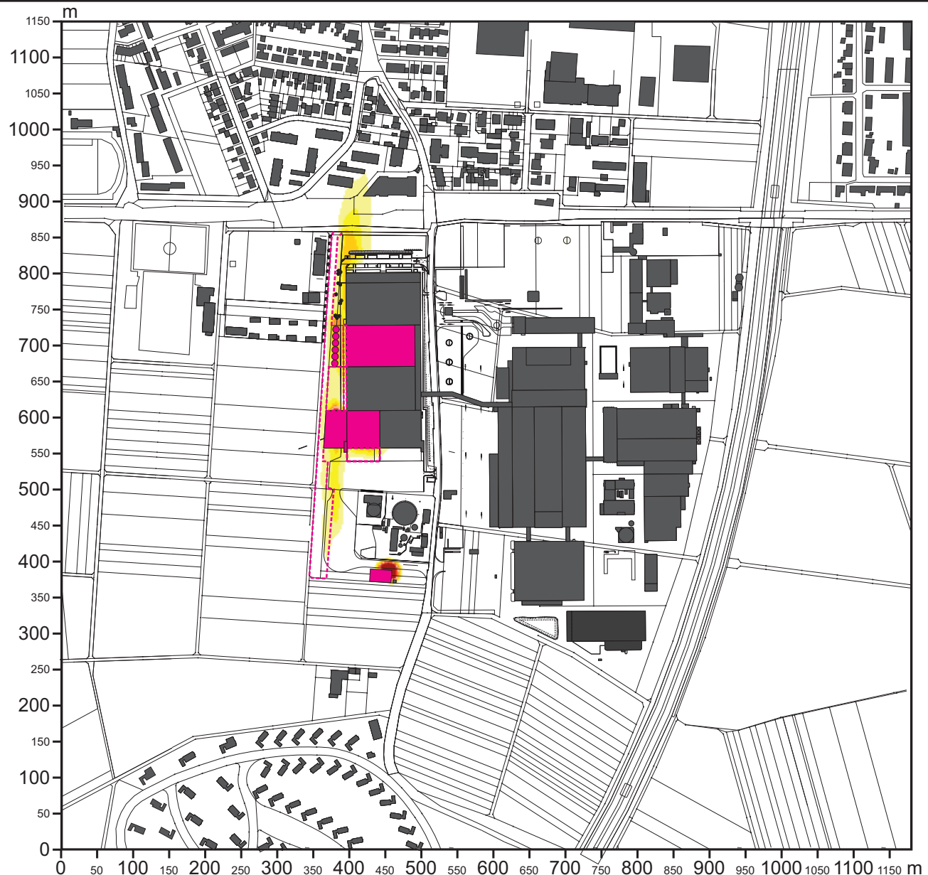
Abb. 17.3 Vorher-Nachher-Vergleich / Ergebnisse mikroskaliger Lufttemperatursimulationen Modifikation der Lufttemperatur 2 m ü.G. (14 Uhr) bei einer Anströmung aus Süden mit 2.0 m/s in einer Höhe von 10 m ü.G.
