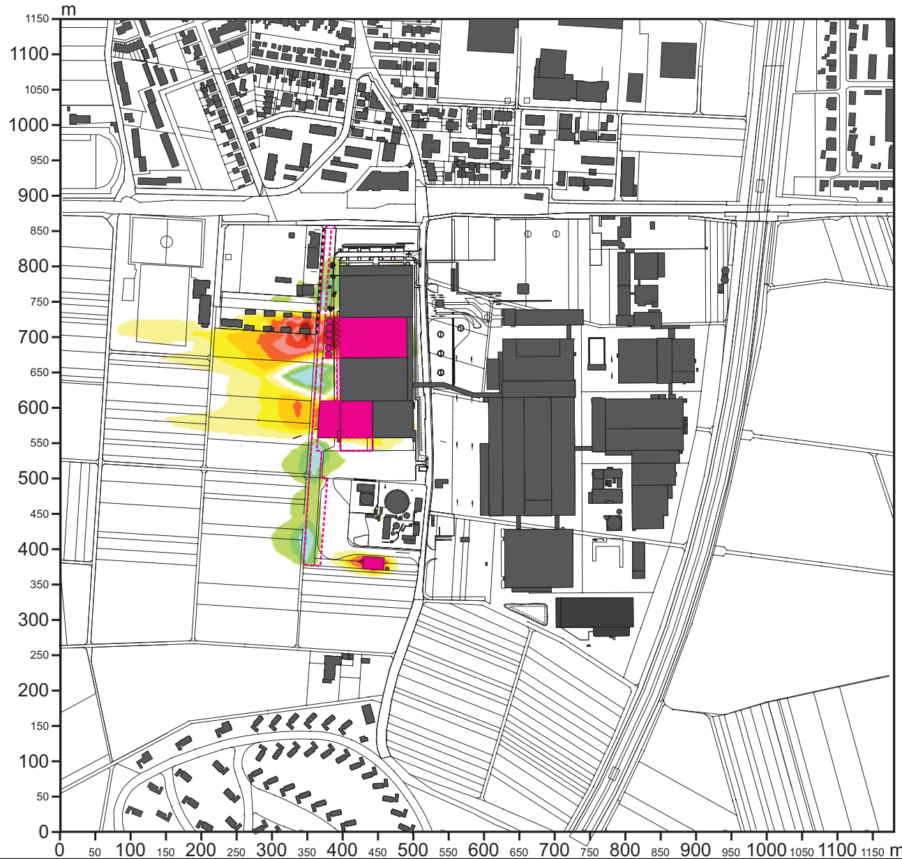
Abb. 14.3 Vorher-Nachher-Vergleich/ Ergebnisse mikroskaliger Strömungssimulationen Modifikation der Windgeschwindigkeit 2 m ü.G. bei einer Anströmung aus Osten mit 2.0 m/s in einer Höhe von 10 m ü.G.
