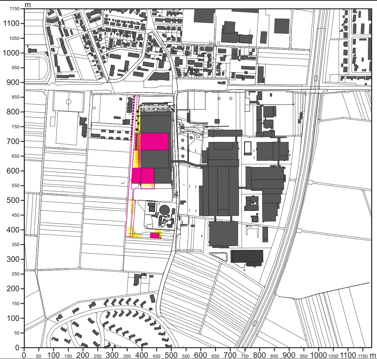
Abb. 19.3 Vorher-Nachher-Vergleich / Ergebnisse mikroskaliger Lufttemperatursimulationen Modifikation der Lufttemperatur 2 m ü.G. (23 Uhr) bei einer Anströmung aus Süden mit 2.0 m/s in einer Höhe von 10 m ü.G.
