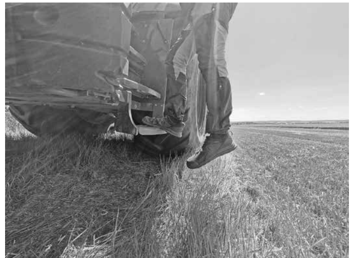
Rückwärts runter, sicher auftreten, hinschauen: Einfache Maßnahmen wie diese wirken Unfällen beim Auf- und Absteigen entgegen Foto: SVLFG
